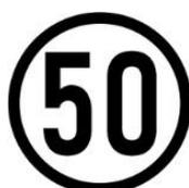
**Begriff**Geschwindigkeits-Vorsignal für Langsamfahrstelle Lafa «Tableau indicateur de vitesse (TIV) à distance»**Bedeutung**Äquivalent zu Entspricht FDV R 300.2, Bild 218. Wenn  $v_{max} \leq 40$  km/h, ist dieses mit der gelben Scheibe ergänzt
