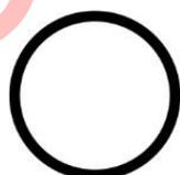
**Begriff**Endsignal Langsamfahrstelle Lafa «-TIV de fin de chantier-»**Bedeutung**Äquivalent zu Entspricht FDV R 300.2, Bild 220. (Die verminderte Geschwindigkeit gilt, bis das letzte Fahrzeug an diesem Signal vorbeigefahren ist)
